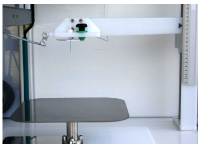
CNC-gesteuerter X-Y-Tisch mit Flachkollektor
